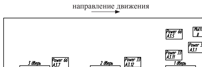
Рисунок 4.10.2 – Схема расположения блоков мультиплексной системы
